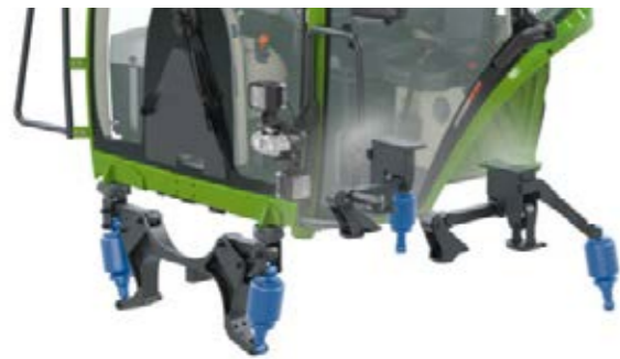
La suspensión de la cómoda cabina es neumática y está apoyada en cuatro puntos; además, cuenta con autonivelación integrada que reduce las vibraciones al mínimo.
