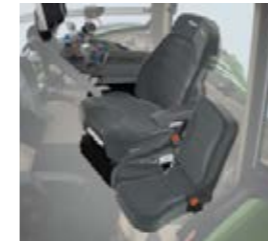
El nuevo asiento de confort Dual Motion Fendt Evolution resulta especialmente cómodo y ergonómico y cuenta con calefacción, climatización y respaldo Dual Motion que acompaña el movimiento.
