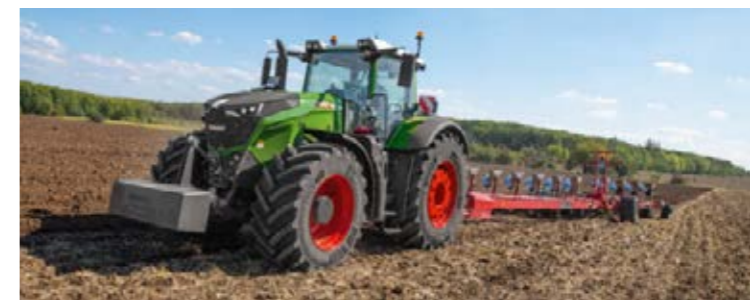
Gracias al sistema de gestión del tractor TMS y a la regulación automática de carga límite 2.0 el tractor adapta las revoluciones del motor de modo óptimo a la velocidad en carretera.
