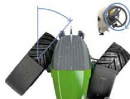
VarioActive permite conseguir un giro completo con solo un movimiento del volante.
