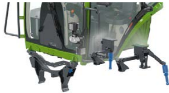
La suspensión mecánica de la cabina se sostiene en la parte delantera sobre dos cojinetes cónicos y en la parte trasera sobre dos elementos de suspensión mecánica.
